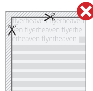
■ Fig. 2: Texte bitte immer mit einem Sicherheitsabstand zur Schneidekante anlegen. // Fig. 2: Please insert text always with a safety margin from the cutting edges.
